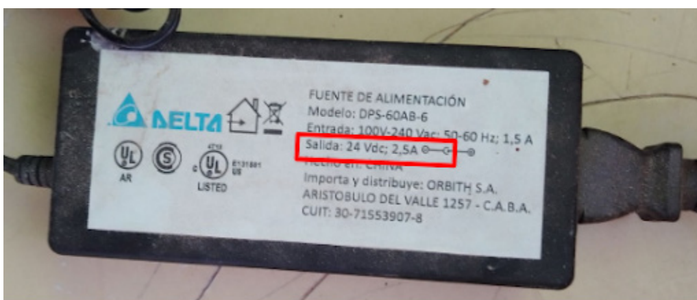
Figura 71. Etiqueta de información técnica de un cargador de modem Delta, medida en voltaje y amperaje
