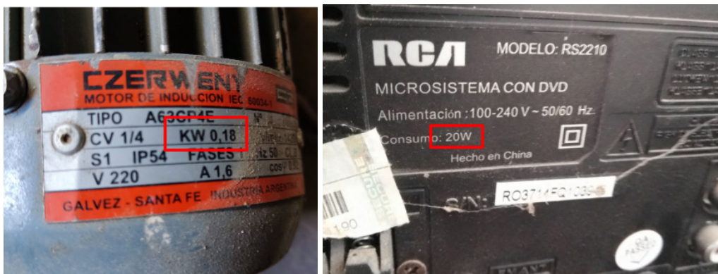
Figura 70. Etiqueta de información técnica de un televisor RCA (consumo medido en W) y de un bombeador (consumo medido en kW 18 )
